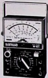
Dubbelbereik- schakelaar N/101 Meetbereiken: DCV, DCA, ACV, Ohm, DB.
